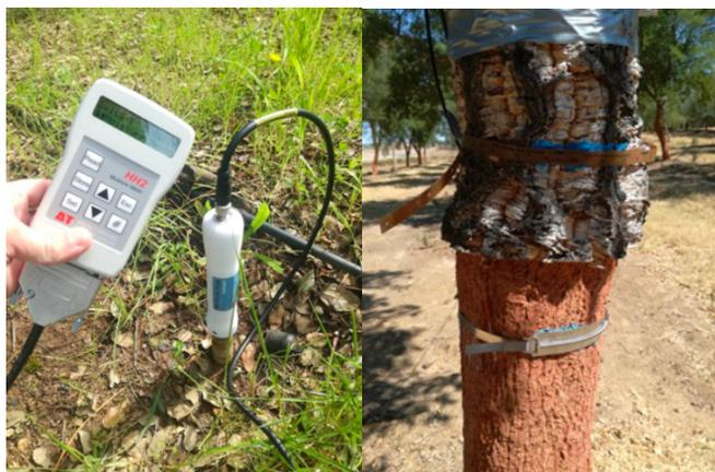
Figura 2 – Medição pontual de humidade do solo (a) Dendrómetros em cortiça virgem e de reprodução (b)
